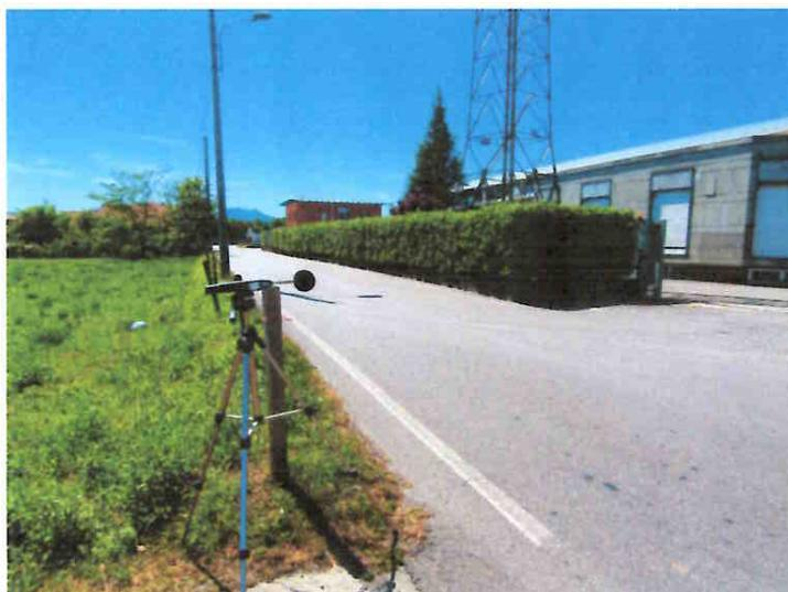
**Misurazione fonometrica eseguita nel punto "P1".**
