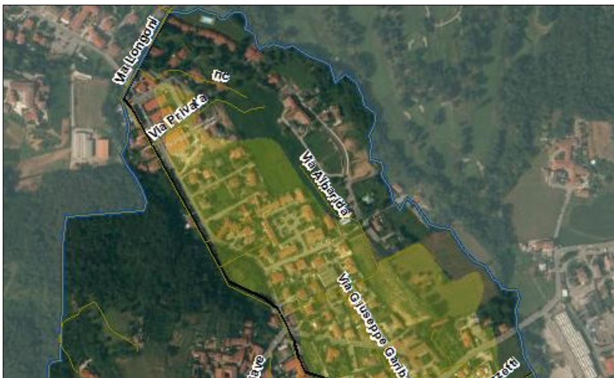
Per la zona di Arzenate si rileva che la situazione topografica della zona non favorisce il deflusso naturale delle acque verso il torrente Borgogna e, al contempo, il sistema di drenaggio esistente delle acque sia a monte che a valle della zona non è sufficiente a
